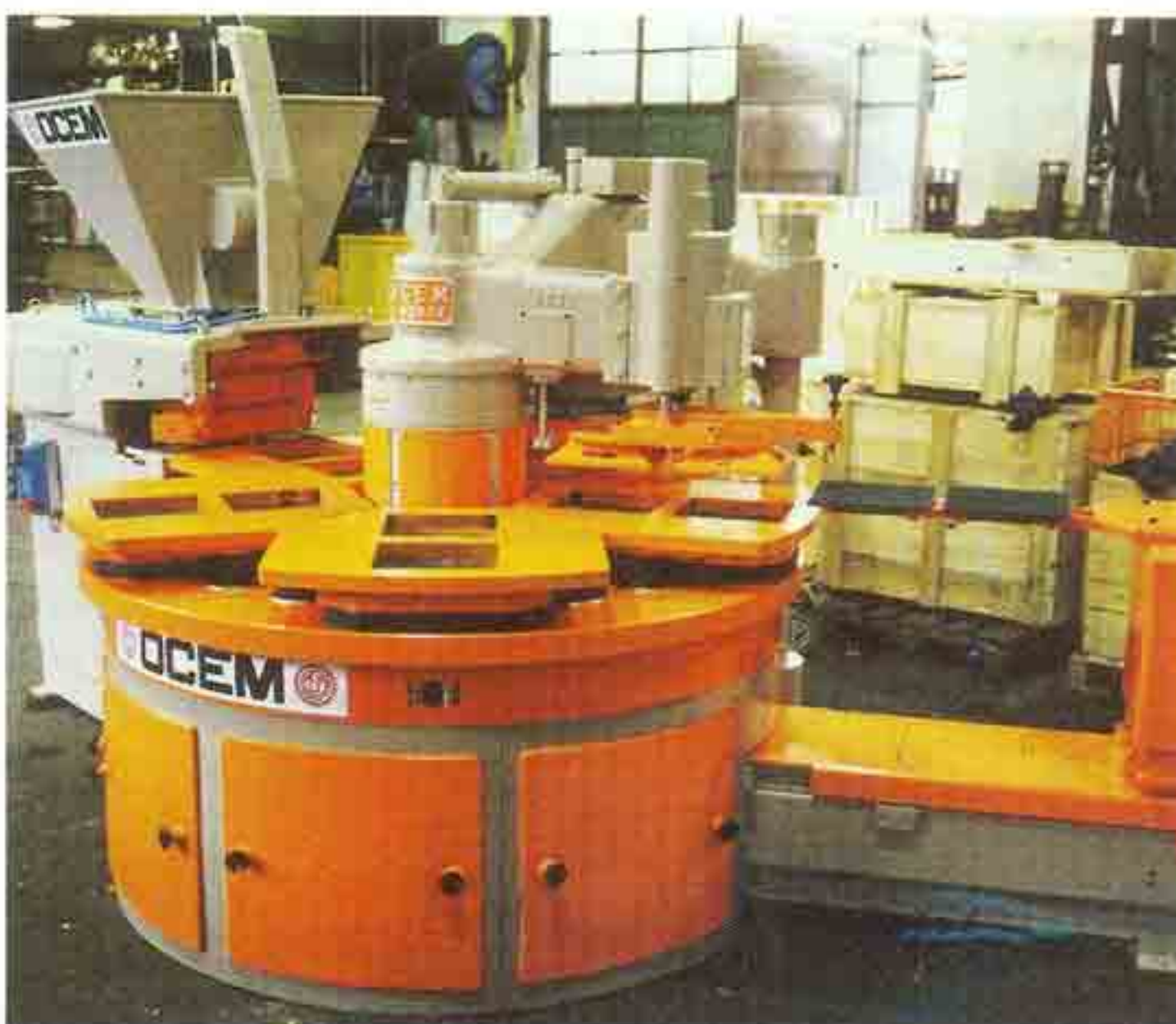
Máy ép 5 trạm model OPA 540\D; model OPA 540\Junior
