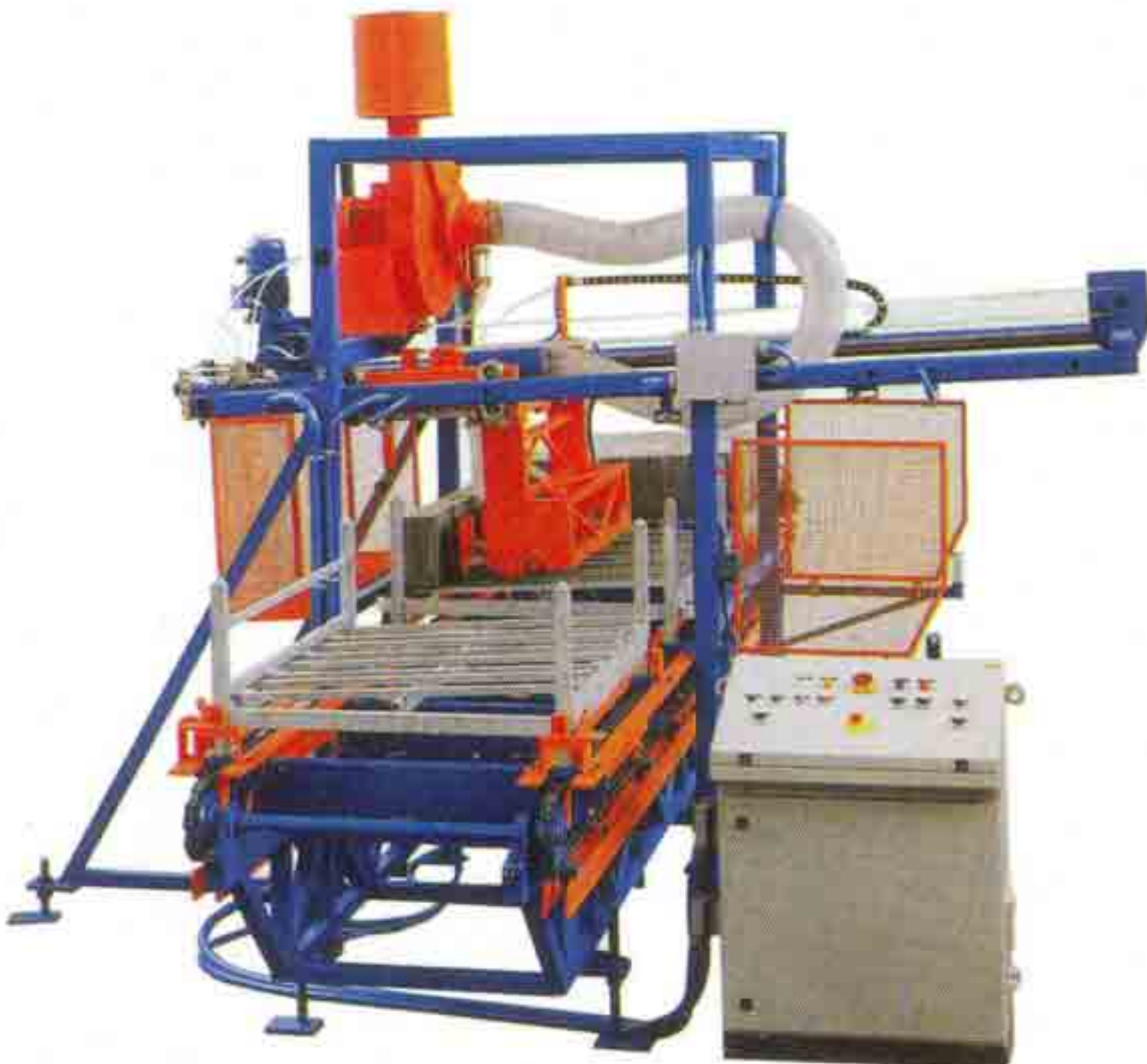
Hệ thống xếp dỡ kiểu Vertimatic EX
