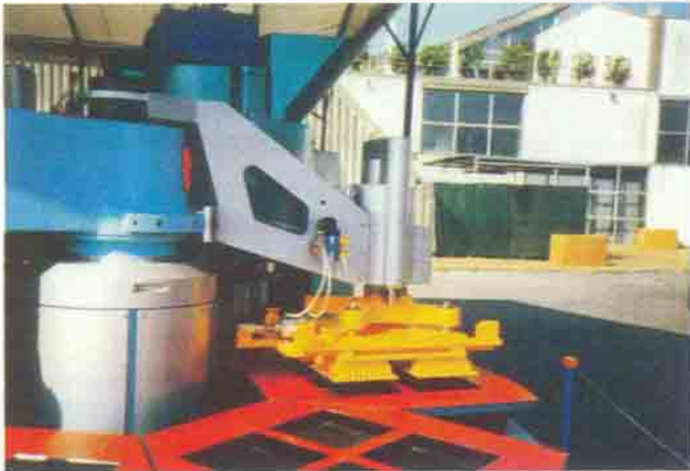
Tổ hợp lưới dao động dùng cho lớp trộn có hạt lớn
