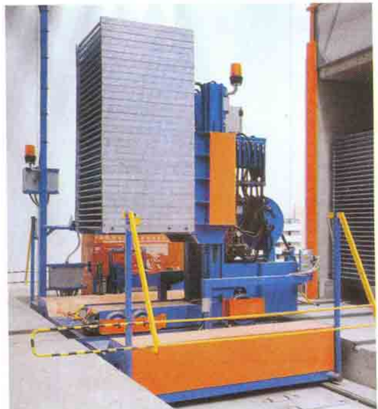
Xe goòng vận chuyển gạch vào ra khu dưỡng hộ Finger Car hoạt động tự động theo chương trình
